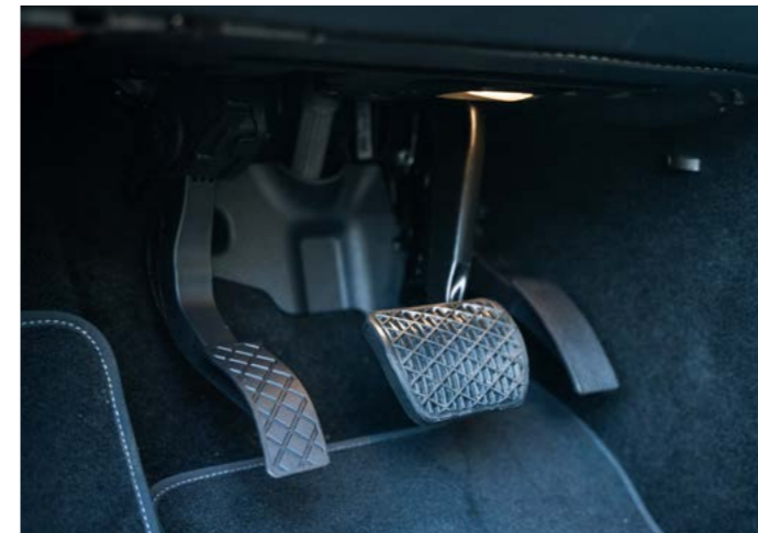
Beim elektronischen Linksgas sind die Linksgaseinrichtung und das Originalpedal über eine Sicherheitselektronik verbunden, die ein Umschalten während der Fahrt unmöglich macht. Das inaktive Pedal kann durchgetreten werden, um den vorhandenen Platz vollständig auszunutzen.
