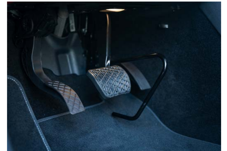
Beim mechanischen Linksgas wird die Funktion des Gaspedals beispielsweise durch ein zweites, linksseitiges Gaspedal übertragen. Dabei wird das Originalpedal mit einer Prothesenstütze abgedeckt. Die Einrichtung kann einfach abgezogen und wieder aufgesteckt werden.
