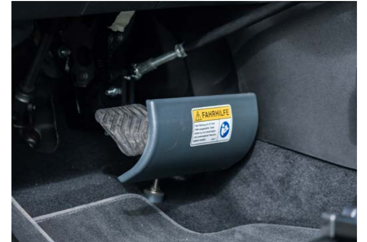
Pedalabdeckungen sind ein wichtiges Sicherheitselement, das ungewolltes Betätigen der Pedale zuverlässig verhindert. Pedalaufsätze verkürzen die Distanz zu den Pedalen um 50–100 mm und sind individuell einstellbar.
