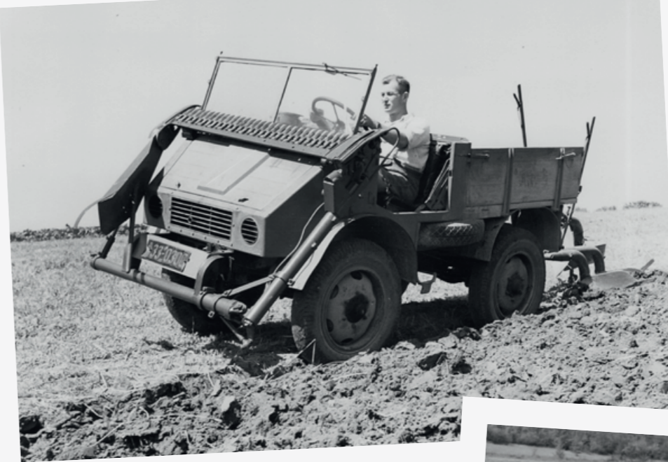
Der erste gebaute Unimog U1, hier mit Frontmäherwerk, Pflug und ausgehängten Türen, das Verdeck ist zusammengeklappt.
