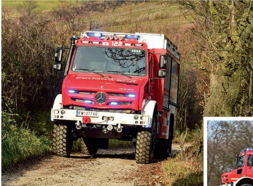
Untersetzungsgelände, Differenzialsperren und eine Wadfähigkeit von 1,2 Metern
