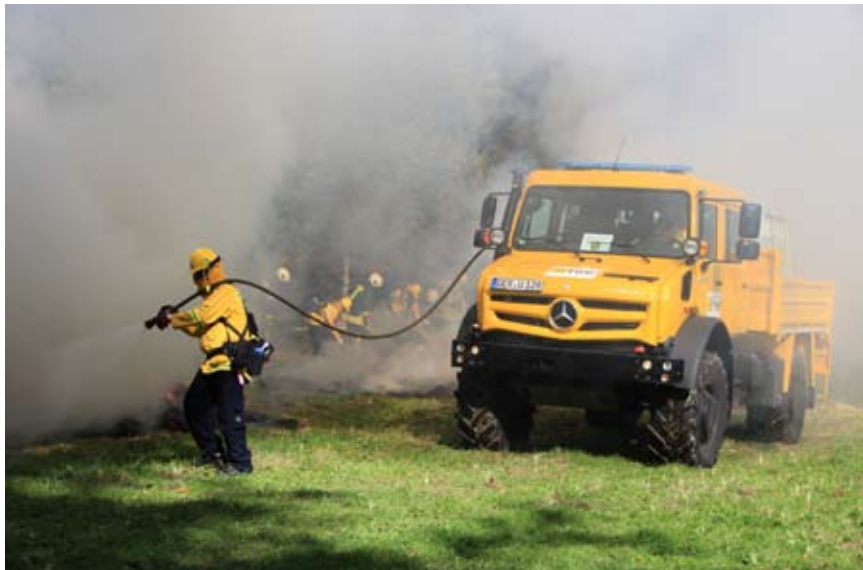
Unimog U 5023 als behelfsmäßiges WTLF mit zwei aufgesetzten IBC-Behältern (je ca. 1 000 l Wasser) und einer kleinen Motorspritze von @fire im Einsatz zum Ablöschen eines Brandsaumes mittels D-Druckleitung bei der Großübung in der Nähe von Tübingen (Fotos: Mercedes-Benz Special Trucks)
