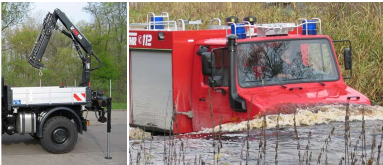
links: Beispiel eines schnellwechselbaren 3,5-mt-Heck-Ladekrans mit hochklappbaren Stützen für gute Geländeeigenschaften bzw. zum Abstellen des Krans. rechts: Der Unimog kann optional mit einer Wadfähigkeit bis zu einer Tiefe von 1,20 Metern ausgestattet werden.
