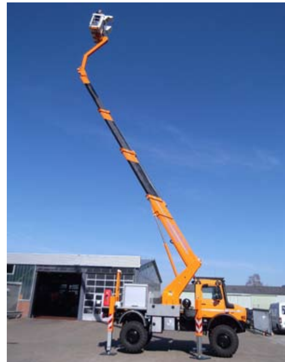
Beispiel einer kompakten Arbeitsbühne, wie sie auf der Pritsche des Unimog aussehen könnte.
