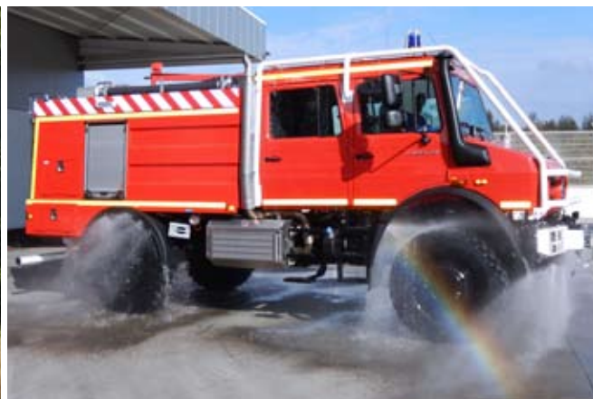
links: Wald- und Vegetationsbrandbekämpfung – ein Fall für den Unimog seit Jahrzehnten rechts: Waldbrandtanklöschfahrzeug aus Spanien. Gut zu sehen sind die Schutzbügel mit den integrierten Selbstschutzdüsen sowie die elektrische Vorbauseilwinde.
