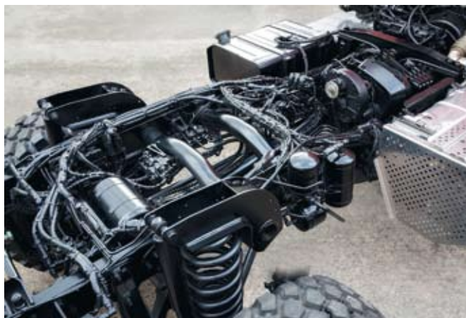
Beim Unimog gibt es mit einem Hitzeschutz ummantelte Leitungen ab Werk.
