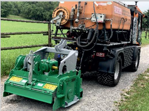
... schafft optimale Voraussetzungen, um beschädigte Schotterdecken oder marode Bitumenbeläge größtenteils ohne Zugabe von abzubauenen Schottermaterialien an Rad- und Wanderwegen zu pflegen oder instand zu setzen.
