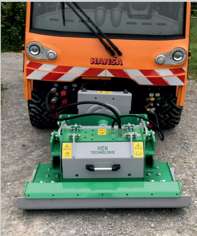
In Verbindung mit dem aufgebauten Wasserbehälter und der optional verfügbaren Wassersprühleiste kann in einer Überfahrt die optimale Feuchtigkeit des zu verdichtenden Materials eingestellt werden
