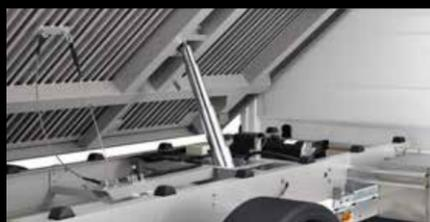
**Elektr. betriebene Kipphydraulik** sorgt mit Hydro-Elektro-Aggregat und voll verchromtem Hydraulikzylinder für nötigen Auftrieb. Höhere Nutzlast - Kipper in Aluminium-Ausführung.
