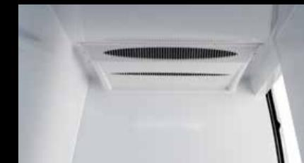
**Kompakter Verdampfer.** Dank der leistungsstarken Auslassdüsen wird die kalte Luft optimal und schnell im Laderaum verteilt.
