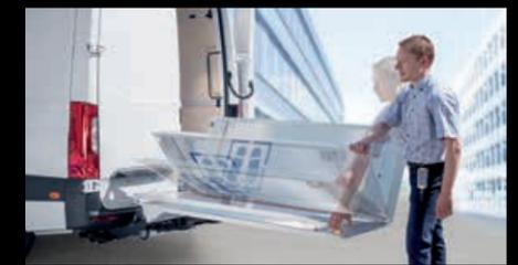
**Klappbare Bordwand.** Durch die klappbare Bordwand jederzeit schneller Zugang über die rechte Hecktür.
