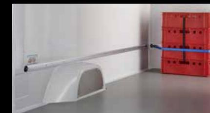
**Airline-Schienen im Kühlfrachtraum,** rundumlaufend, für die Ladungssicherung mit Spanngurten und Sperrstangen.
