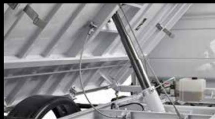
**Hydro-Elektro-Aggregat.** Ein geräuscharmes Hydro-Elektro-Aggregat kippt die Ladefläche nach drei Seiten. Extrem robuster Kipper in Stahlbauweise.
