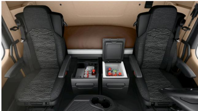
Auch unterwegs sehr gut gelagert: der Kühlschrank in der Schublade unter dem Bett sorgt für geeignete Kühltemperaturen für Getränke und Lebensmittel. Er wird über einen Schalter an der Instrumententafel aktiviert. Die Kühlleistung ist, unabhängig von der Umgebungstemperatur, über einen Thermostat regelbar.
