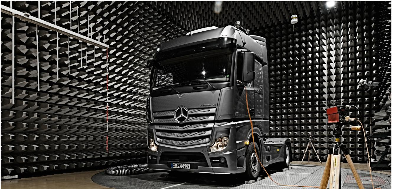
EMV-Prüfung in einer speziell vor elektromagnetischen Fremdstörungen abgeschirmten Halle.
