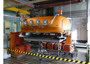
Hydropulsprüfstand zur Simulation
