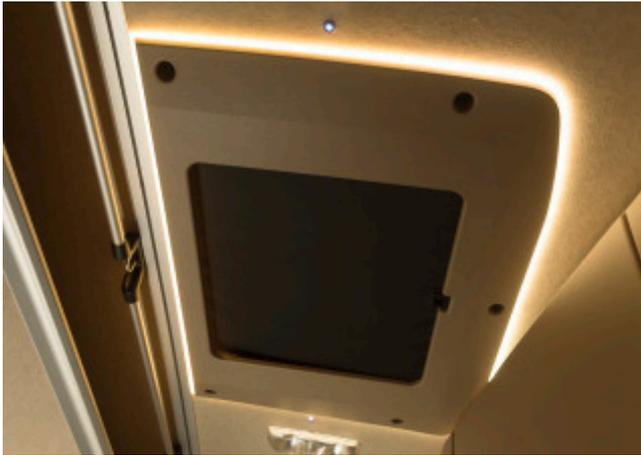
Mit der Ambientebeleuchtung mit insgesamt 136 LEDs für das Schiebe-Hebedach in Glas-Ausführung gestalten Sie das Licht in der Fahrerkabine ganz nach Ihren Wünschen. Die Farbe der LEDs ist auf Tastendruck nach der gewünschten Lichtstimmung wählbar. Sechs unterschiedliche Farben (warmweiß, amber, blau, rot, grün, gelb) sind voreingestellt und schnell anwählbar. Darüber hinaus können sämtliche andere Lichtfarben individuell eingestellt werden und sorgen für ein wohnliches Ambiente im Fahrerhaus.
