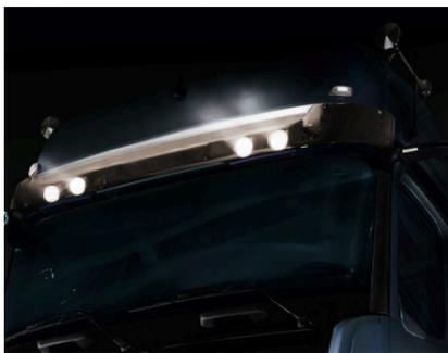
Die vier zusätzlichen runden Fernscheinwerfer mit moderner, energieeffizienter LED-Technik für die Sonnenblende vereinen Design und Technik. Sie bieten eine tageslichtähnliche Ausleuchtung, so wird die Sicht für den Fahrer wesentlich unterstützt. Durch die Integration der Scheinwerfer in die Sonnenblende ist ein Vorteil in Aerodynamik und Gewicht messbar (gegenüber einem Dachlampenbügel mit Zusatzscheinwerfern). Es sind keine weiteren Befestigungspunkte am Dach notwendig.
