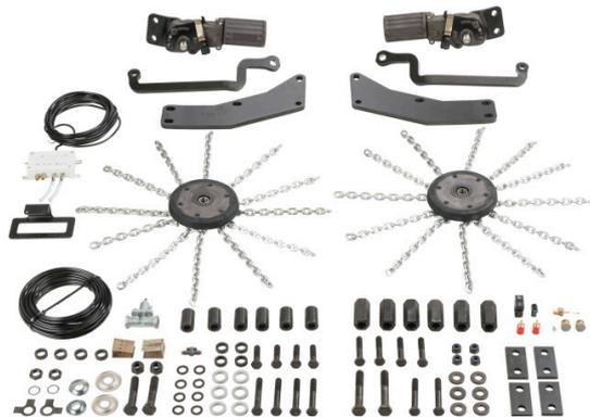
Die Rotationsketten werden per Knopfdruck im Fahrerhaus beim Anfahren oder während der Fahrt (bis 50 km/h) bei glatten und eisigen Straßen zugeschaltet bzw. deaktiviert und in seine ursprüngliche Position zurückbewegt. Die laufruhigen und reifenschonenden Rotationsketten haben eine robuste Aufhängung.
