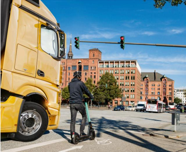
Das Abbiege-Assistenzsystem, basic ist ein Objekterfassungs-System zur Kollisionsvermeidung auf Basis eines 24 GHz Radarsystems. Das System kann die Sicherheit ungeschützter Verkehrsteilnehmer beim Abbiegen über die Beifahrerseite von mittelgroßen und schweren Nutzfahrzeugen (> 3,5 t) erhöhen. Hier wird der Fahrer sowohl optisch als auch akustisch informiert und gewarnt, sofern sich ein bewegliches Objekt in der seitlichen Überwachungszone befindet.
