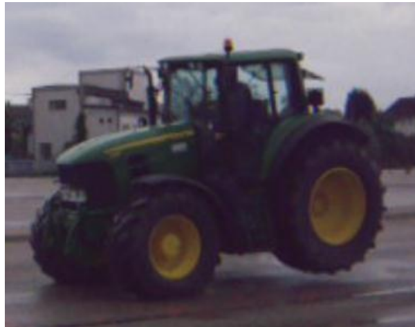
Abbildung 8: Bremsversuch: Hinterachse hebt ab (Quelle: M. Winkelbauer)
