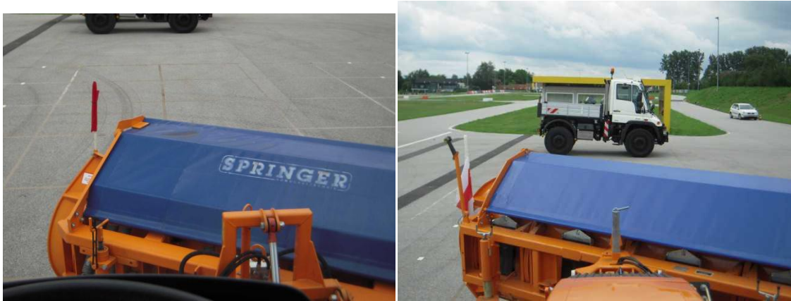
Abbildung 19: Kommunallkw und Traktor: Sicht auf die Fahrbahn bei vorgebautem Schneeschild (Quelle: T. Feßl, KFV)
