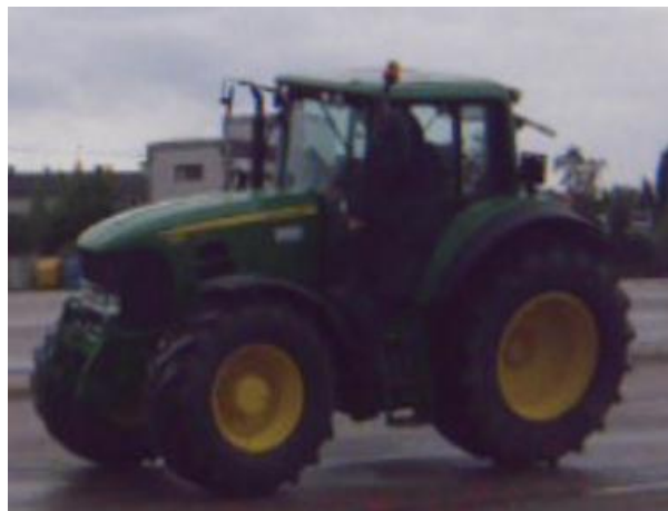
Abbildung 9: Bremsversuch: Aufkommen mit den Rädern der linken Seite (Quelle: M. Winkelbauer)
