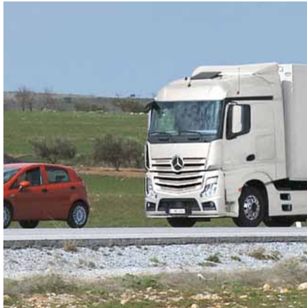
Abstandshalte-Assistent 1) . Das Sicherheitssystem mit Stop-and-go-Funktion unterstützt den Fahrer in stressigen Situationen und reduziert das Risiko von Auffahrunfällen.
