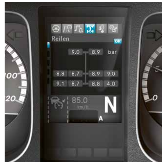
Reifendruckkontrolle 1) . Die drahtlose Drucküberwachung an Vorder- und Hinterachse(n) kontrolliert den Luftdruck aller Reifen des Zugfahrzeugs sowie des Aufliegers oder Anhängers permanent.
